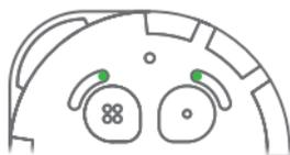
Wenn zwei LEDs auf dem Fob leuchten, muss der Fob aufgeladen werden. Um den Fob aufzuladen, schließen Sie ein USB-Mikroladegerät am Ladeanschluss an. Die Lade-LED leuchtet während des Ladens rot und bei vollständiger Ladung grün. Bitte beachten Sie, dass das Aufladen bis zu 5 Stunden dauern kann.
