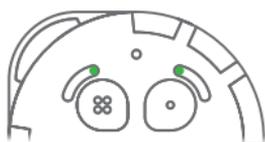
Deux LED s'allumeront sur la télécommande pour indiquer s'il est nécessaire de la recharger. Pour recharger, branchez un câble micro USB sur le connecteur de charge. Le voyant de charge est rouge pendant le chargement et vert lorsque la charge est terminée. Veuillez noter que le chargement peut prendre jusqu'à 5 heures.
