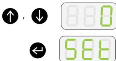
Pour lancer un remplissage lorsque FOD est sur « OFF », appuyez sur le bouton F ou sur les boutons haut et bas simultanément.
