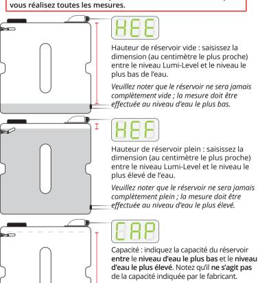
Veuillez noter que la capacité est mesurée en kilolitres. 1,00 kilolitre = 1000 litres. La capacité de saisiemaximale est de 2,00 kilolitres (2000 litres). Exemples : 0,65 = 650 litres | 0,30 = 300 litres Appuyez sur la touche « Entrée » pour contrôler le niveau d'eau (en litres). « LEL » sera affichée avant la lecture.
