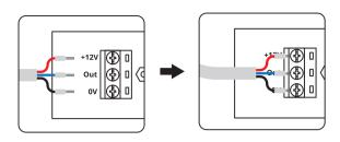
Veillez à respecter la polarité lors de la connexion du Lumi-Level. Le non-respect de cette consigne pourrait endommager l'appareil. Si le câblage est incorrect, l'appareil ne fonctionnera pas
