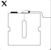
Découpez autour du gabarit de perçage, fixez-le au sommet du réservoir et percez les trous. Consultez les instructions de placement pour obtenir plus d'informations sur le placement. Pendant la phase de perçage, évitez que les copeaux ne tombent dans le réservoir.
