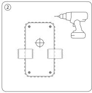
Consultez le gabarit de perçage pour voir la taille des trous. Évitez que des copeaux ne tombent dans le réservoir lors du perçage pour éviter d'endommager le système.
