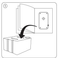
Découpez le gabarit de perçage de ce manuel et fixez-le sur le réservoir en suivant les instructions de placement.
