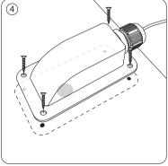
Placez le Lumi-Level sur les trous percés, en vous assurant que l'ouverture du laser est dans le bon sens, puis fixez-le avec les vis fournies.
