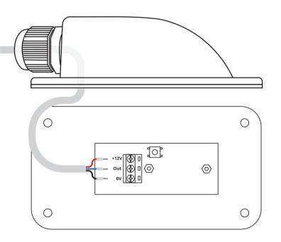
L'interrupteur sur le Lumi-Level sert uniquement à la calibration par le fabricant.
