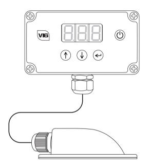
Connectez le contrôleur de pompe conformément à ce schéma. REMARQUE : ne montez le fusible qu'une fois toutes les connexions effectuées.
