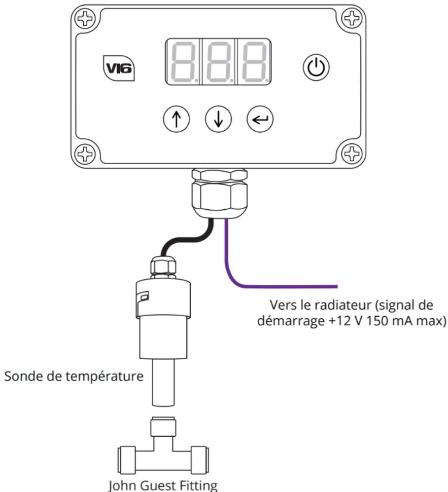
Connectez le contrôleur de pompe conformément à ce schéma.
