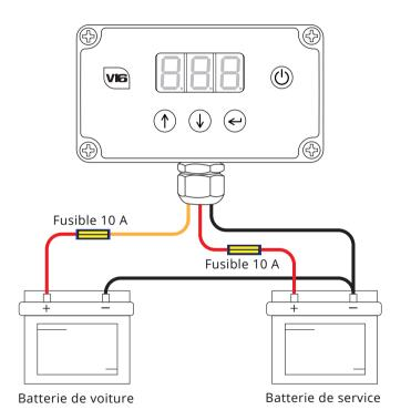
Connectez le contrôleur de pompe conformément à ce schéma. REMARQUE : ne montez le fusible qu'une fois toutes les connexions effectuées.
